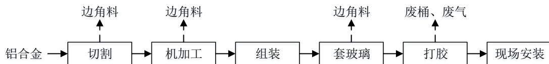
图 2.8-10 铝合金门窗生产工艺流程及产排污环节
